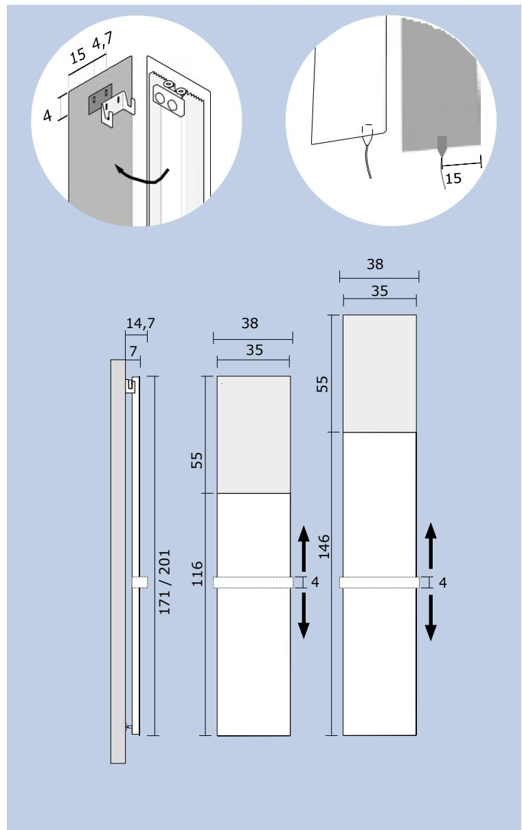
Electric with schuko plug / Version électrique avec prise schuko / Elektromodell mit schukosteckdose / Versión electrica con enchufe schuko
